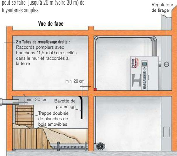
Le silo peut se trouver à un niveau inférieur à celui de la chaufferie, cela ne pose aucun problème pour le système de transfert pneumatique Hargassner.
