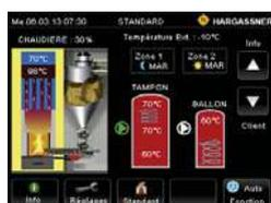
**Chaudière en fonctionnement à puissance réduite :**
